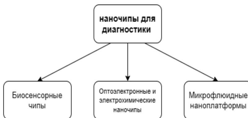
Рисунок 2 - Типы LOC, используемых для диагностики.
